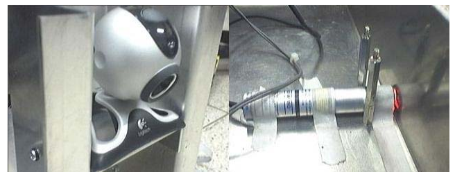
(그림 4) Logitech사의 QuickCam 4000 Lanics사의 658nm파장의 Line Laser
