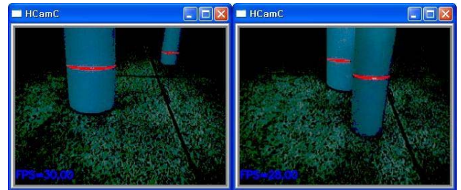
(그림 3) 카메라를 통해 잡힌 장애물에 나타난 라인 레이저 패턴
