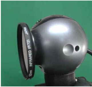
(그림 5) 카메라에 적외선 필터를 장착한 모습
