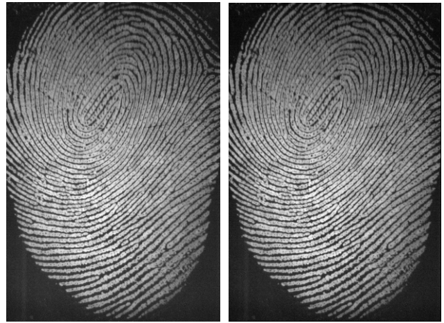
<a- 원 지문영상> <b- 히스토그램 스트레칭 영상> (그림 3) 원 지문영상과 개선된 지문영상
