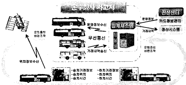
<그림 1> 교통카드 버스시스템 구성
