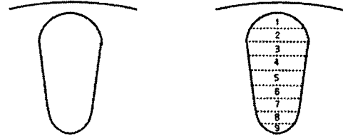
(a) 회전자 바 (b) 회전자 바의 분할도 그림 2 회전자 바의 형상과 분할도
