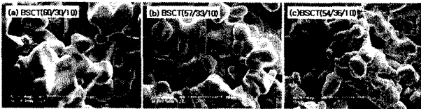
그림 2. BSCT 조성비에 따른 SEM 미세구조
