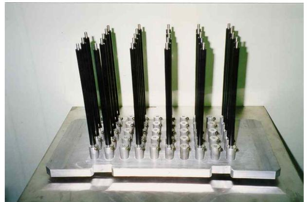
그림 2. 도전성 탄성체 Roller의 Sample
