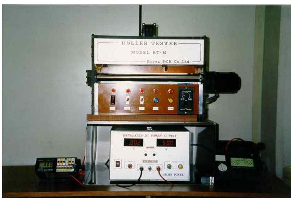
그림 3. Roller의 특성 시험장치
