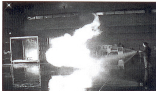
그림 4. 직사분사 위주의 유류 화재에 대한 소화성능 실험과정
