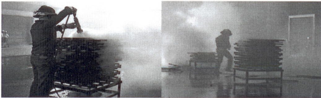
그림 2. 목재 화재에 대한 미세물분무 및 직사분사 위주의 소화성능 실험
