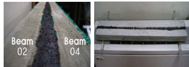
Fig 3. 제진재가 삽입된 샌드위치 콘크리트 보
