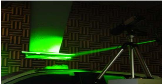
그림 2. 실차 풍동 PIV 시험 장면
