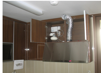
Fig. 2 레인지 후드 소음 측정방법(KS C 9304) 및 측정사진
