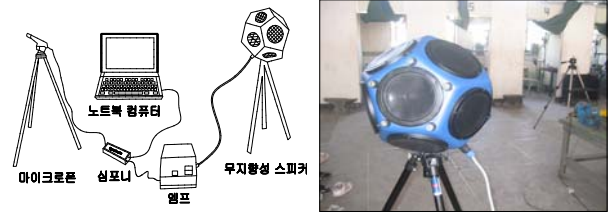
(b) 작업장 잔향시간 측정장비 및 측정모습 그림 3. 측정장비 구성 및 측정모습
