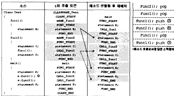
[그림 3] 함수 호출 스택을 이용한 함수 선형화 방법
