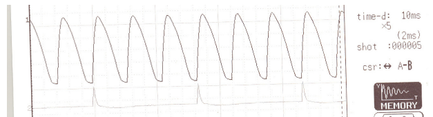
<그림 11> 정류기 출력전압(부하 정격계자전압 120[Vdc])
