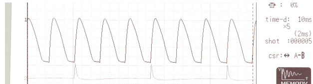
<그림 10> 정류기 출력전압(부하 정격계자전압 101[Vdc])
