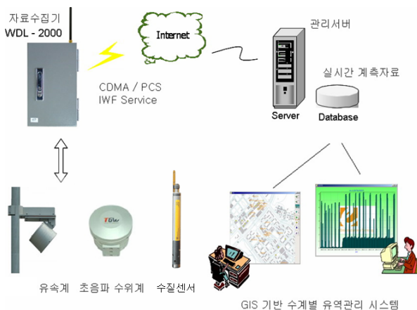
<그림 1> 전체시스템 하드웨어 블록도
