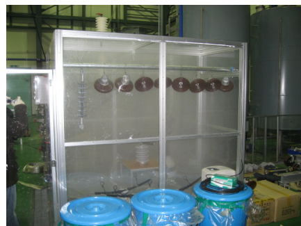
<그림 1> 상용주파 습윤섬락시험 챔버
