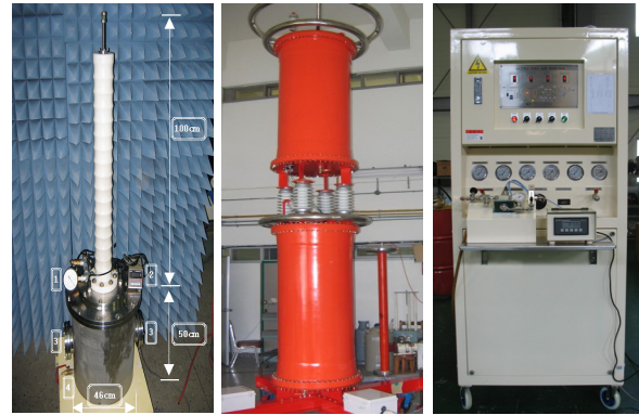
<그림 1> 실험용 모의 GIS 챔버, AC 300[kV] 전원장치 & Dry-Air 건조장치
