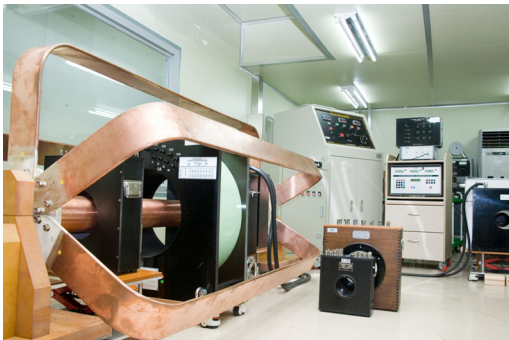
〈그림 1〉 자체 개발한 20 kA 전류변성기 교정시스템
