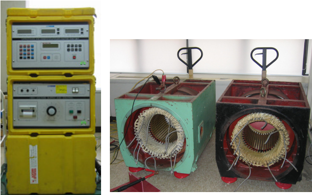
<사진 1> 고전압 발생 및 시험장비와 시험 권선을 포함한 모터
