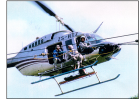
〈그림 4〉 Aerial Rack Work 방식
