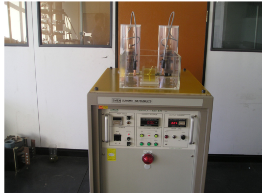
<그림 2.3> 절연파괴전압 측정장치
