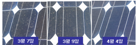
<그림 2> 환경요인에 의한 태양전지모듈의 표면 변화
