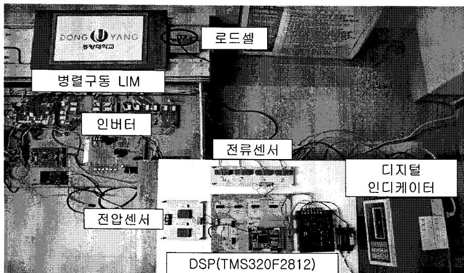
그림 2. 병렬 운전 LIM의 계측시스템 사진
