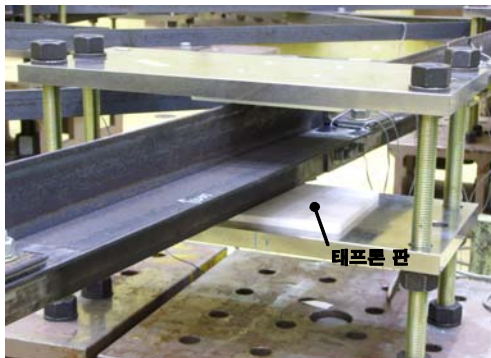
그림 6. 테프론을 이용한 면외 좌굴 방지용 지그 설치형상
