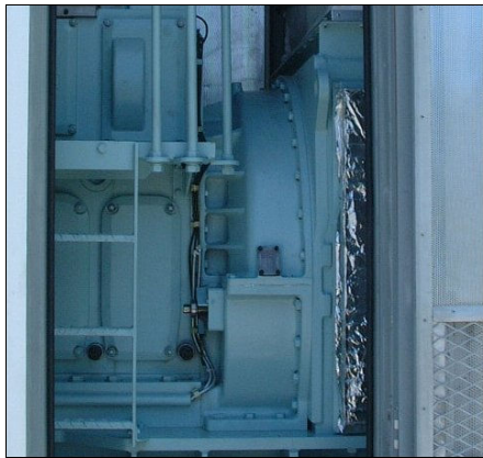
Fig. 15 주물 구조로 된 상하부 flywheel cover
