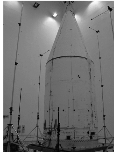
그림 3. 음향 챔버내 설치된 시제 및 치구 조합체
