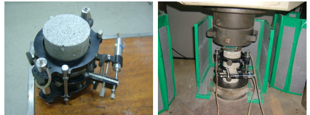
사진1. 경량콘크리트판넬 시료 탄성계수 측정장면
