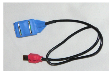
그림 1. 본 논문에서의 근전도 센서.
