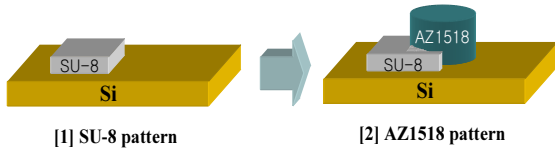
그림 1. 기판위에 동시에 patterning 된 SU-8 과 AZ-1518 layers
