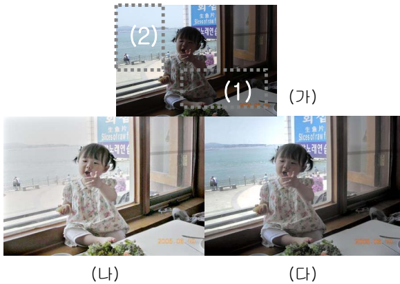
그림 3 (가) 역광 사진 (나) 기존 Retinex 결과 (다) K-Retinex 결과
