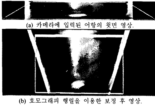
그림 3 어항의 깊이 정보를 추출하기 위하여 호모그래피 행렬을 사용, 어항의 윗면의 왜곡을 보정.
