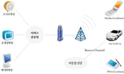
(그림 1) DMB 서비스 구성 개념도
