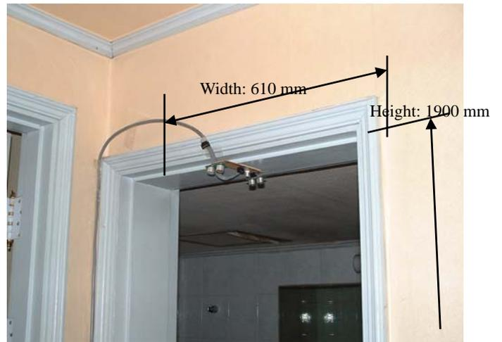
그림 2. 실험 장치: 센싱 모듈 장착 실시 예
