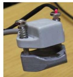
그림 1. 촉감 제시 장치와 위치 및 방향 센서.
