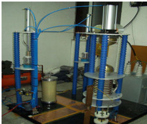
그림 3 서지발생장치의 사진 Fig. 3 Photograph of surge generator
