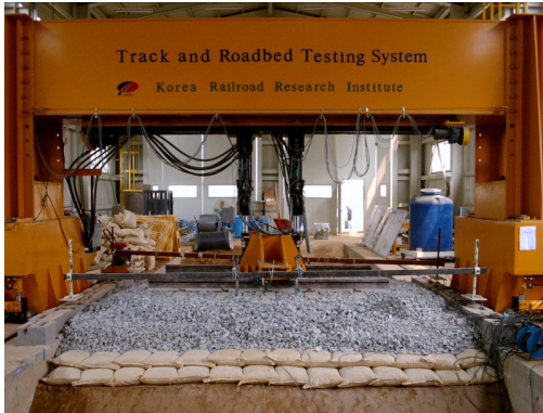
Fig. 1 종합궤도노반 실험장치 전경
