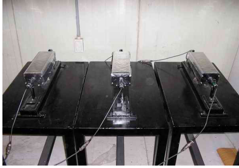
<그림 6> 주입모르타르의 자기수축 시험
