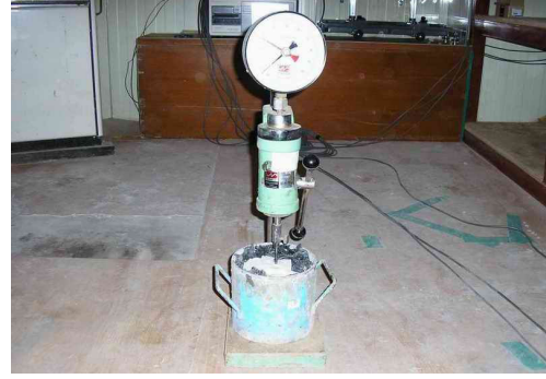
<그림 7> 주입모르타르의 관입저항 시험
