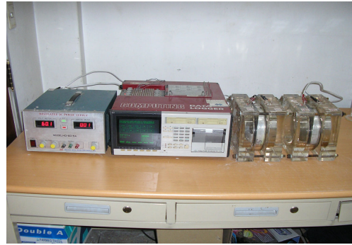
<그림 5> 염소이온 침투 저항성 시험
