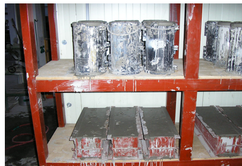
<그림 4> 프리팩트 콘크리트 양생
