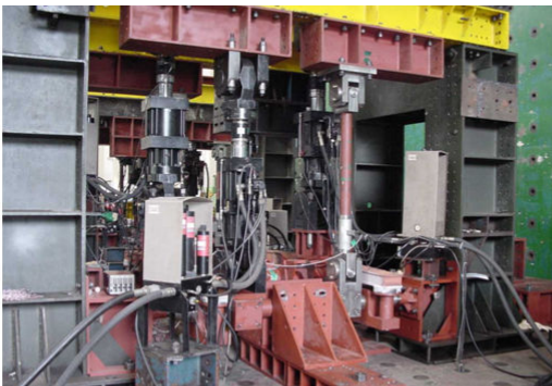
그림 5. 개발 대차 정하중 및 피로시험
