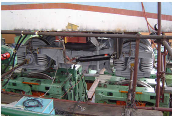
그림 6. 개발 대차의 주행 성능 시험
