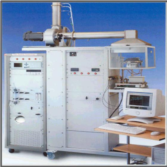
그림 1. dual-Cone Calorimeter 장비
