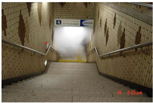
Fig. 22 공기 유입에 따라서 연기가 승강장으로 전파되지 않는 상황 (Case 3)
