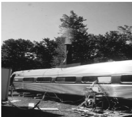
그림 1 배연덕트를 이용하여 발열량 평가를 시도한 사례
