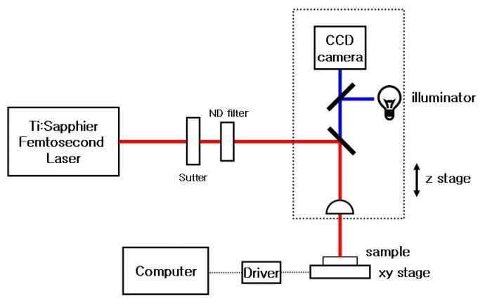
그림 1 펨토초 레이저를 이용한 실험 개략도
