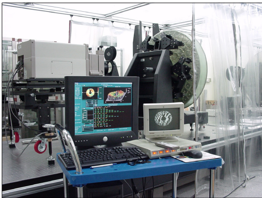
그림 4 시준기의 파면오차 측정 모습
