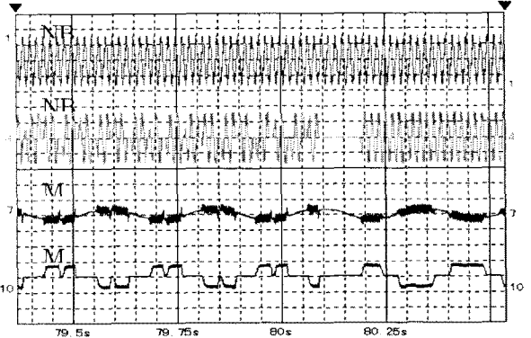
[그림 7] 기동 시 MB/NB측 전압 전류 출력 파형
