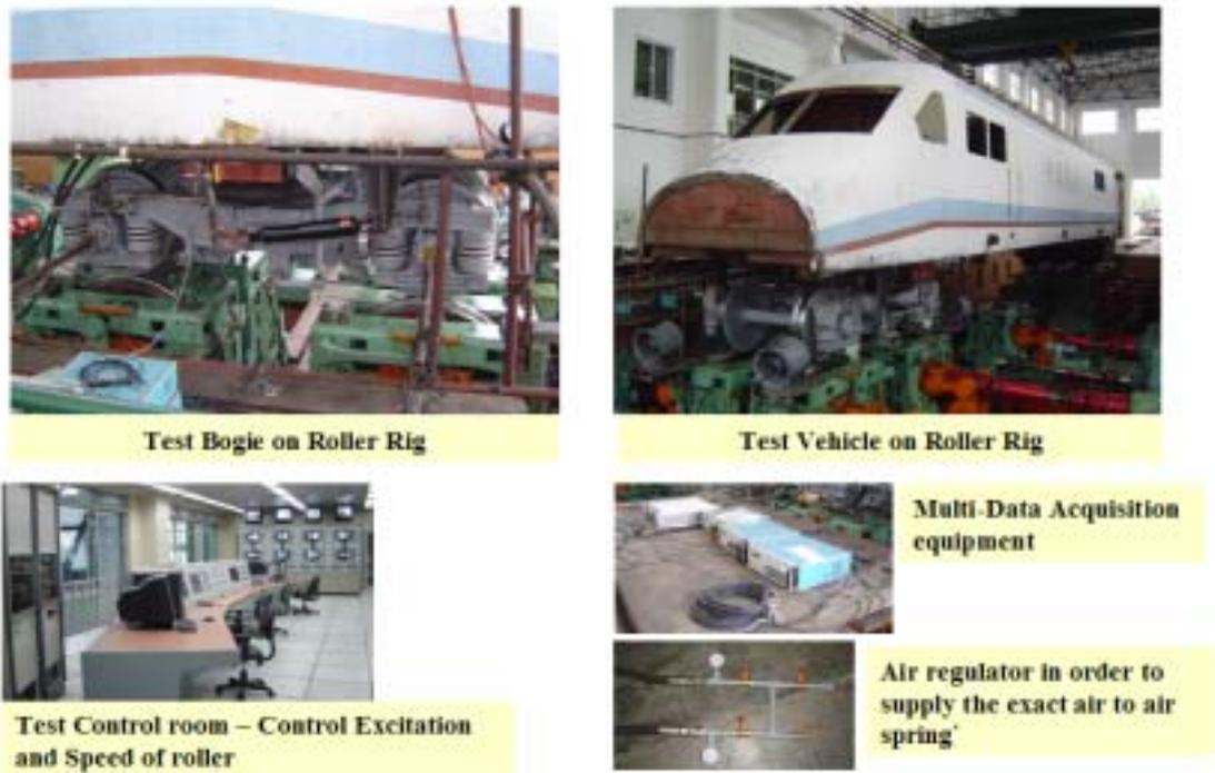
그림 7. roller rig 시험 중인 개발 대차 및 시험 장비
