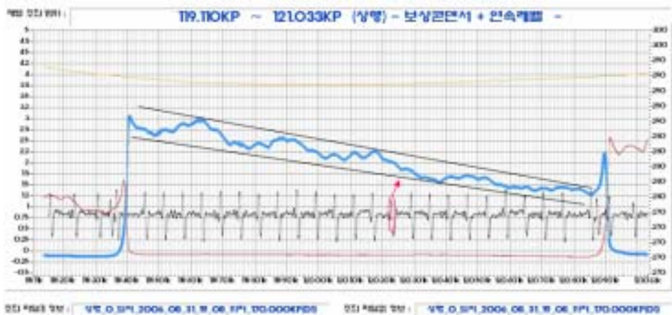
그림 5. 보상 컨덴서에 저항 0.5Ω을 연결한 경우의 측정 값
