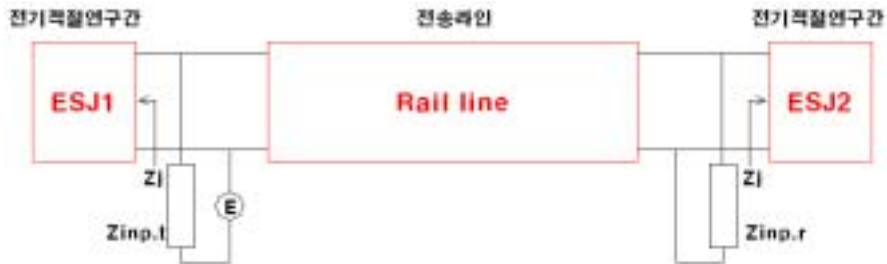
〈그림 3〉 궤도회로의 전기적 절연구간과 전송라인 구분
