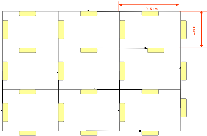
그림 1 소형케도열차시스템 표준적용 선로네트워크 및 역사배치
