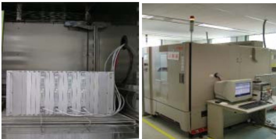
그림 6. 공인기관 온도 시험기 및 자체제작 지그를 이용한 신뢰성 시험 실시
