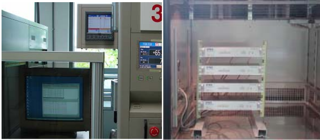
그림 7. 공인시험기관 온도시험기 및 자체제작 지그를 사용하여 신뢰성시험 실시
