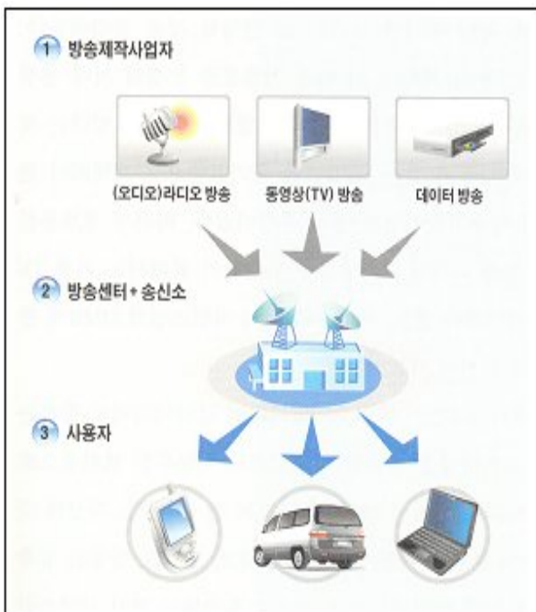
(그림 3.1) 지상파DMB 서비스 개념도
