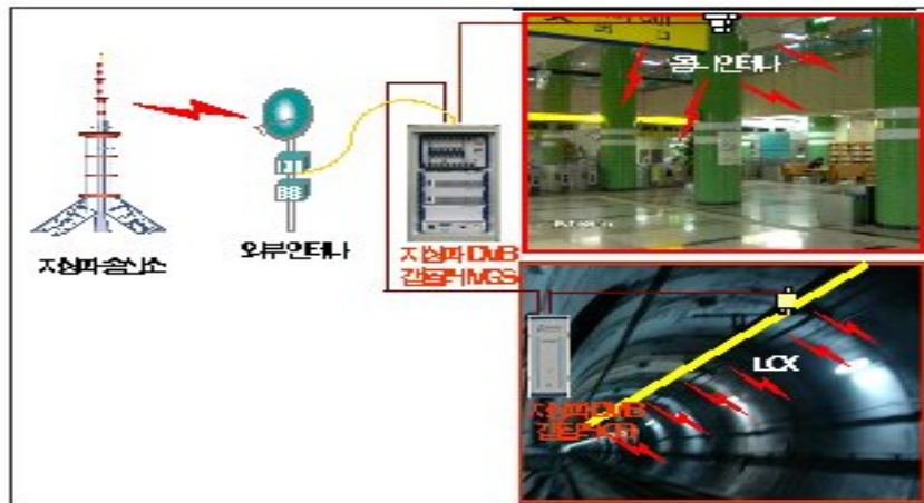
(그림 4.2) 지하철 및 터널내 지상파DMB 망구성도
