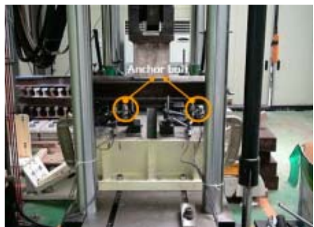
그림 3 레일체결장치 반복하중재하 시험
